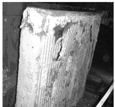
图 6 火山渣混凝土墙片的破坏图
